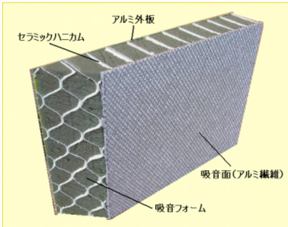
ハニカム材とフェノールフォームとの複合材料を用いて従来の1/3以下の厚み、重量を実現した吸遮音パネルを開発しました。この複合材料は、わずか約30mmの厚さで50dB以上の低騒音化を達成しただけでなく、新たに開発したフェノールフォームにより、高い吸湿性、不燃性、電磁波遮断性、ホルムアルデヒド吸収・分解性を付与しています。
